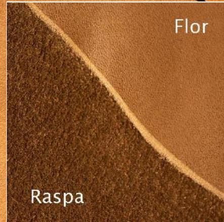
A pele (ou couro) na fase molhada pode ser dividida horizontalmente após a depilação ou curtimento por uma grande "máquina de divisão" fazendo duas fatias uniformes. O lado superior é chamado de "flor" e a parte inferior é chamada de "raspa" ou "carnal". A parte superior é a mais utilizada, e dela se produzem os couros de flor integral. A raspa pode ser acabada ou usada como camurção.
