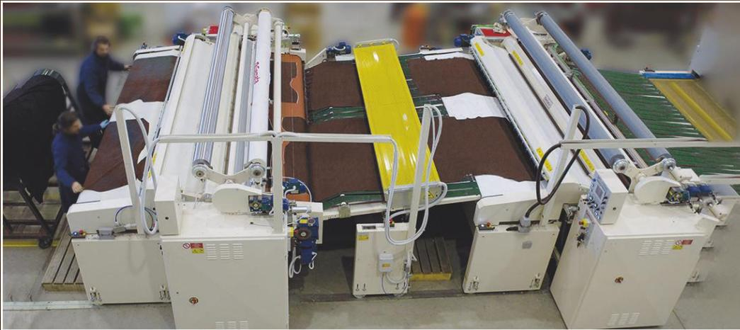
Deux applicateurs à rouleaux pleine grandeur fonctionnent en tandem. Les opérateurs peuvent y insérer deux bandes en même temps ou un cuir pleine taille.
