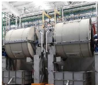
**Les foulons en polypropylène** permettent d'éviter les taches métalliques, l'abrasion de la fleur et améliorent la normalisation du processus.
